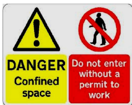
Figura 7 – Exemplo de sinalização de espaço confinado
