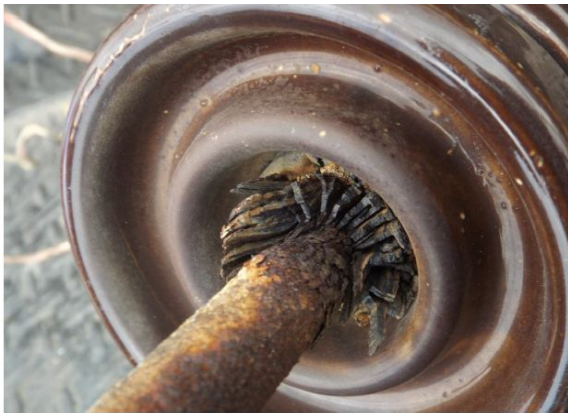
Isolador danificado por corrosão nas ferragens. Fonte: Própria.
