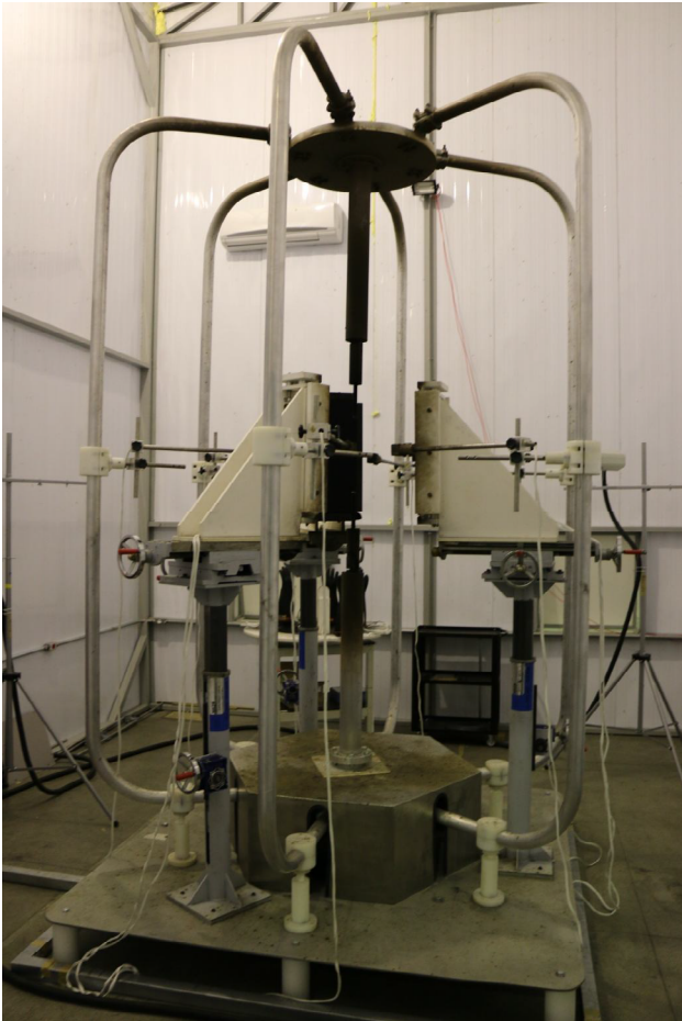
Fig. 4: Arranjo de gaiola de ensaio com painéis separados simetricamente em 120° do LEVe (IEE-USP).
