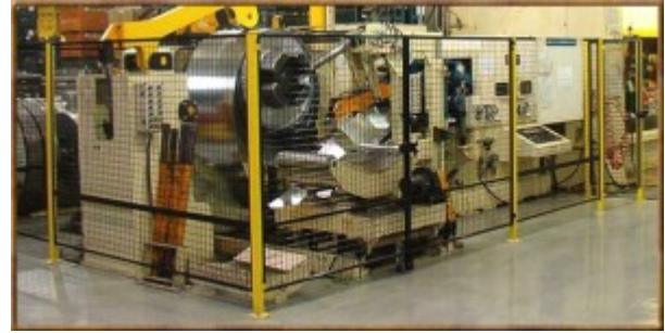
Figura 1 – Isolamento de uma máquina como medida de proteção coletiva.
