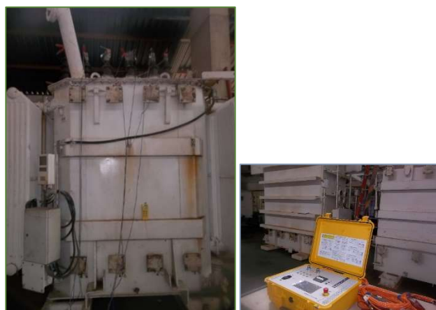
Fig.1. Realização de ensaio de resistência dos enrolamentos: a) conexão no transformador de potência (de 6,25 MVA, 69/13,8 kV); e b) instrumento de medição
