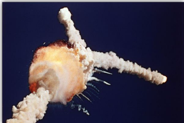
Figura 1 - Explosão do ônibus espacial Challenger, em 28/01/1986, lançado apesar dos reconhecidos problemas, pela NASA, existentes nas juntas de vedação dos tanques de combustíveis dos foguetes ( History Channel )
