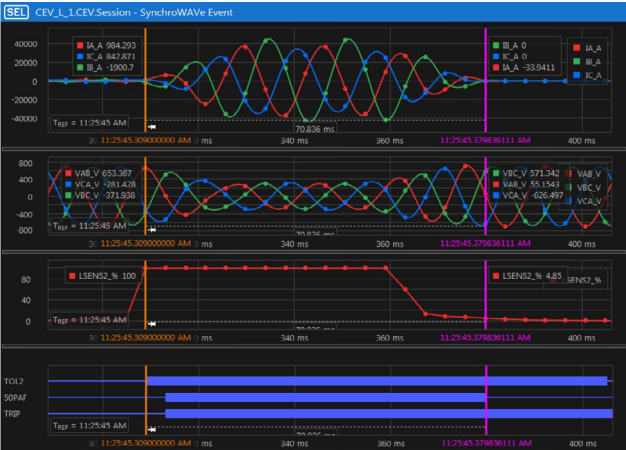
Figura 7 – Oscilografia do relé de proteção contra arco elétrico instalado no CCM
