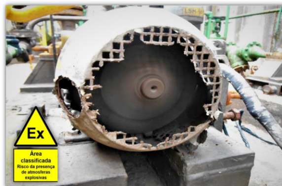
Figura 3 – Motor elétrico com certificação “não acendível” (Ex “nA”) encontrado instalado em área classificada com tampa defletora corroída e danificada, com a exposição do ventilador externo
