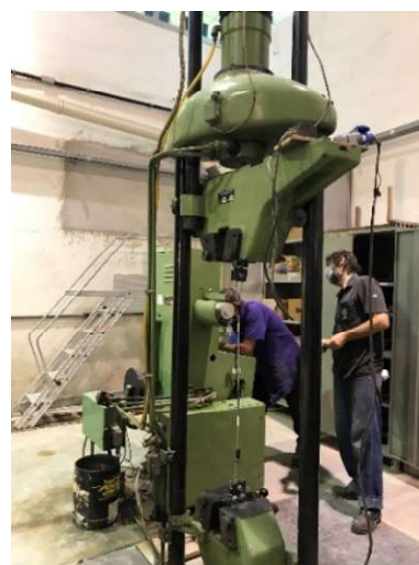
Fig. 10: Ensaio estático de tração
