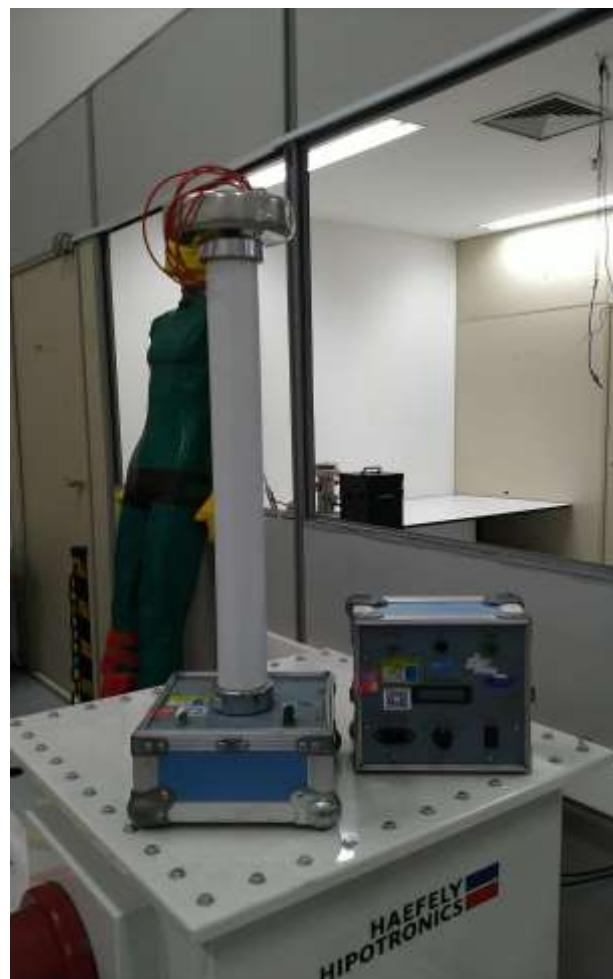
Figura 6: Quilovoltímetro utilizado para estabelecimento da rastreabilidade metrológica aos ensaios.
