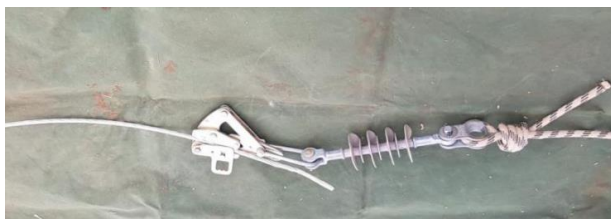
Figura 10: Arranjo para manuseio de cabo conectado ao SEP Fonte: Dos autores
