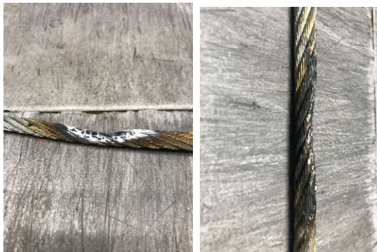
Figs 9: Carga Nominal 300C – a) alma de aço – b) alma de fibra
