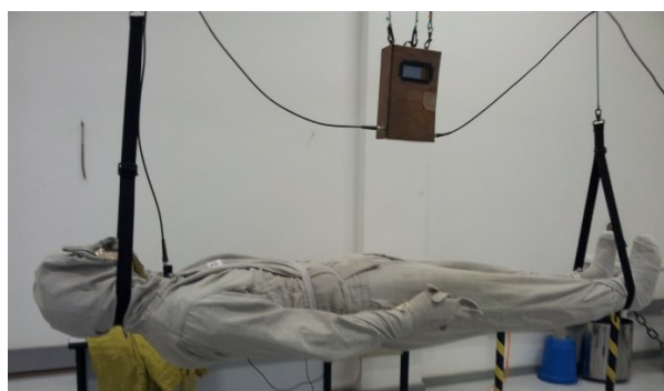
Figura 2: Ensaio em vestimenta condutiva.
