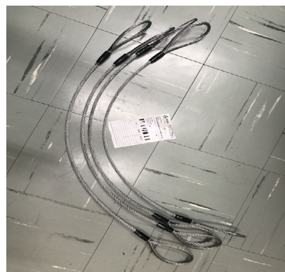
Fig. 3: Amostras tipo alma de aço (AACI)
